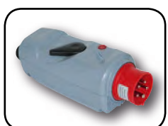
CEE-0-1 выключатель- ML0 Вилка 32A 5P 400V с фазоинвертором • 0-1 выключатель: AC22A, 10kA
